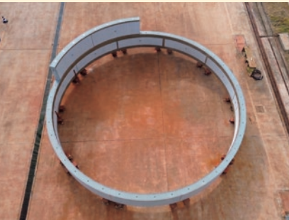
五面鋼殻合成セグメントの水平仮組立試験
