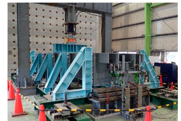
STEEL-C.A.P.工法を適用した合成桁の載荷実験
