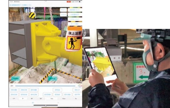
保全工事用ARシステム
