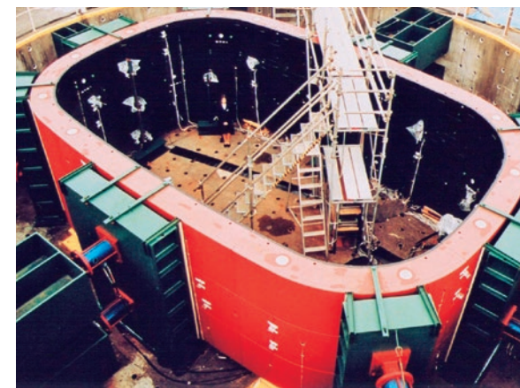
実物大でのリング載荷試験
