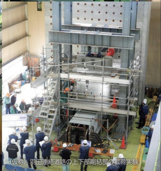
(仮称)羽田連絡道路の上下部剛結部の載荷実験
