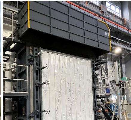
外壁の耐火性能試験 (商品開発)
