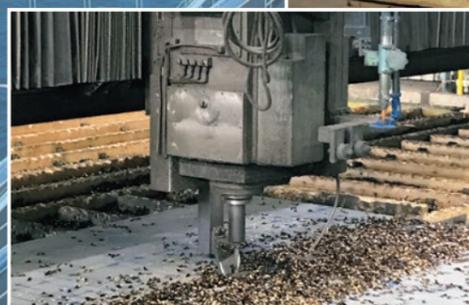
調達した鋼板を設計した形状に切断します。鋼橋は工場から現場へ運ぶことが可能な大きさのブロックに分割して製作します。また橋を構成するブロックどうしを接合する方法としてボルトを用いるのが一般的です。そのために切断した鋼板の接合箇所にはボルト孔をあけます。
