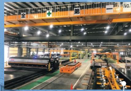
yess建築は、国内唯一のシステム建築専用工場生産体制を整えたことにより、高品質の部材を短納期・低コストで安定供給することを可能にしています。
