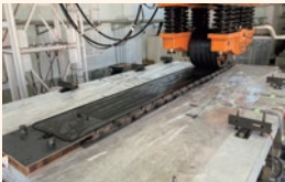
合理化継手の移動輪荷重試験
