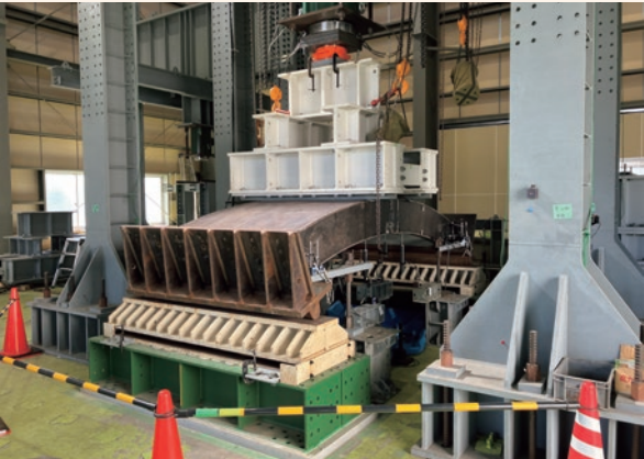
五面鋼殻合成セグメントの曲げ性能確認試験
