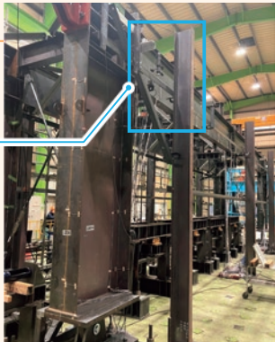
2軸の繰返し載荷試験
