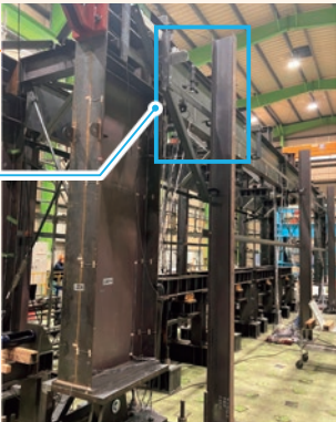
2軸の繰返し載荷試験
