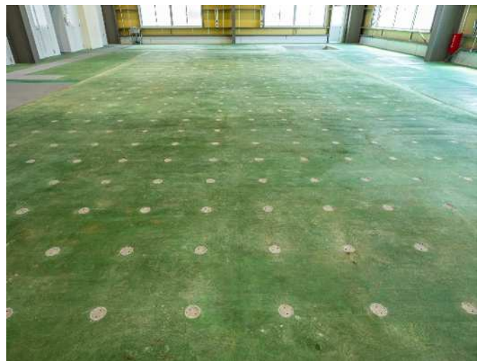
反力床 (500 mmピッチでアンカー可能)
