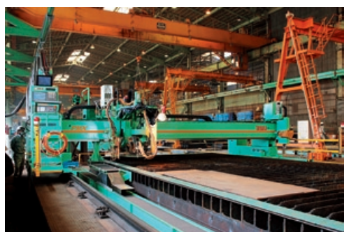
NCプラズマ切断機
