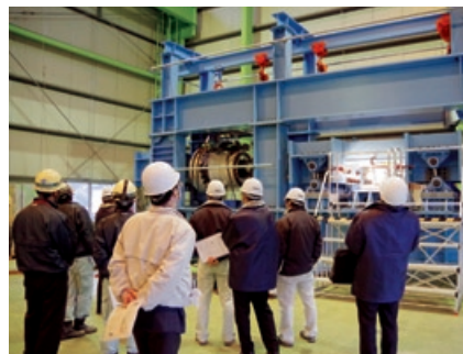
大型試験機によるガセットダンパーの実験
